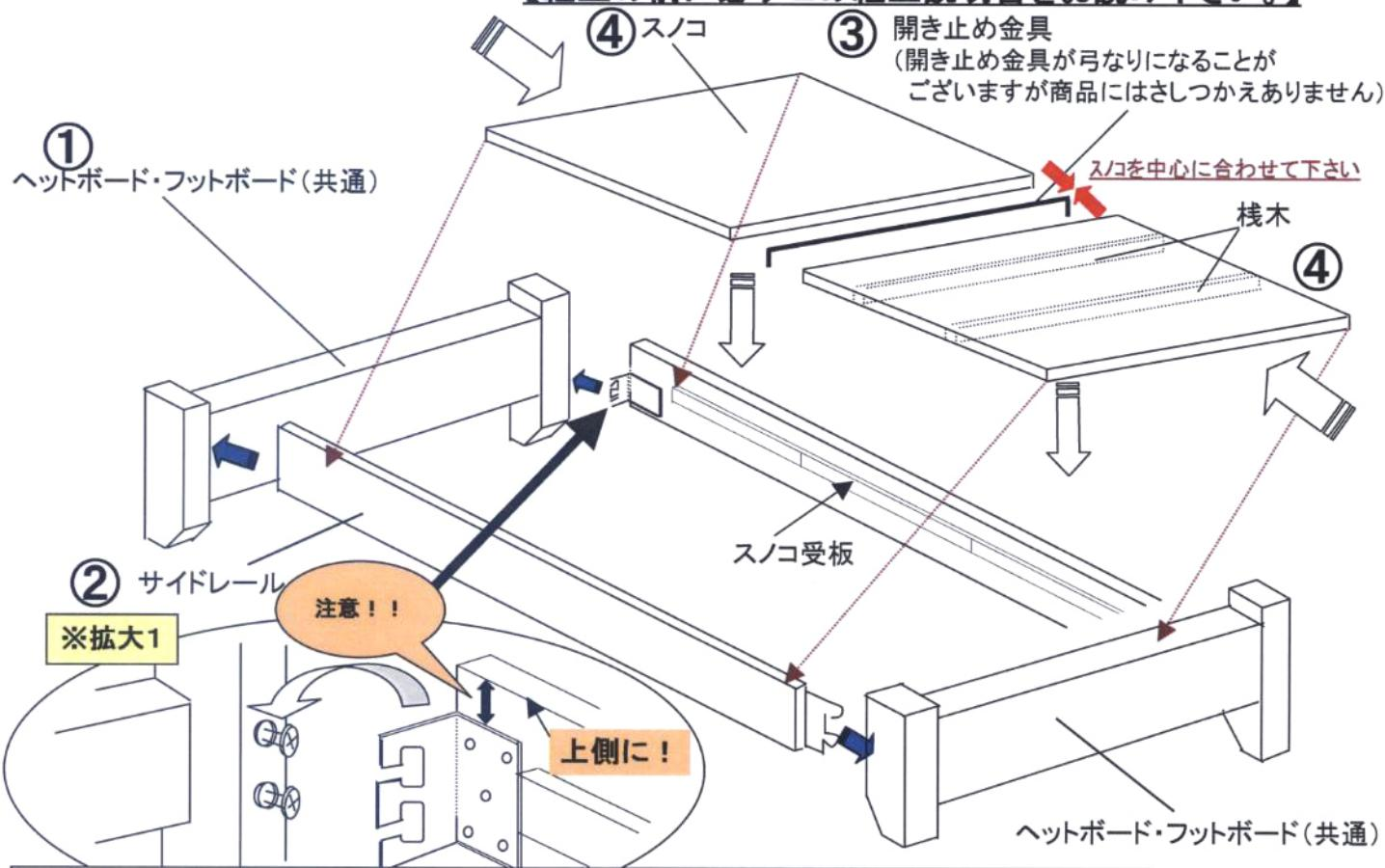
ヘッドボードに付属のボルトを仮止めして下さい。次にサイドレールをボルトに引っ掛けて下さい。
