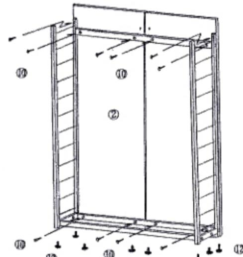
1 ①本体枠を左右にならべ、③補強バーを下部の前側に、④補強バー(穴あり)を後側の上下段に⑨ビスで板止めします。★③補強バーは、取り付け穴が2ヶ所あけてあります。お好みの位置に取り付けて下さい。
