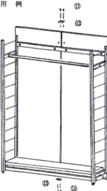
2 本体枠の後側に②背面板を⑩木ネジ(大)で10ヶ所固定し、板止めしたビスも完全に固定して下さい。つぎに⑫アジャスターを本体枠、背面板の下側8ヶ所に取り付けます。
