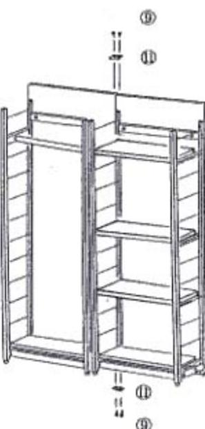
2 本体枠の後側に②背面板を⑧木ねじ(大)で6ヶ所固定し、仮止めしたビスも完全に固定して下さい。つぎに⑩アジャスターを本体枠、背面板の下側6ヶ所に取り付けます。
