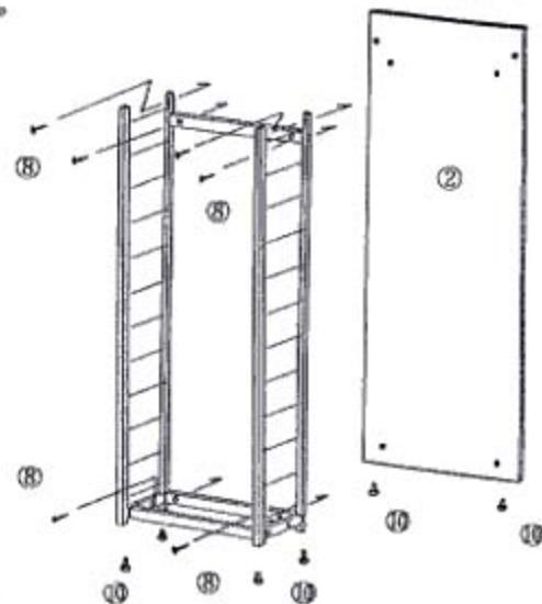
1 ①本体枠を左右にならべ、③据強バーを下部の前側に、④据強バー(穴あり)を後側の上下段に⑦ビスで仮止めします。★③据強バーは、取り付け穴が2ヶ所あけてあります。お好みの位置に取り付けて下さい。
